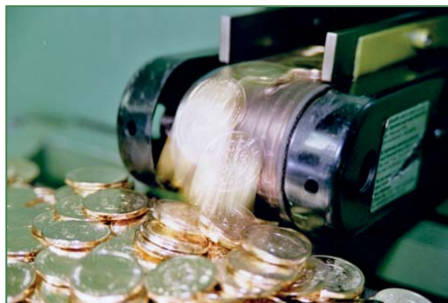
En prægemaskine på Den Kgl. Mønt kan producere 700 mønter i minuttet. I alt producerer denne og to lignende maskiner alle de mønter, der er i omløb i Danmark. Mønterne præges med en kraft på 35 til 90 tons afhængig af mønternes størrelse og tykkelse.
